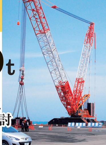
クレーンで重量物を吊るときのクレーンの脚に掛かる荷重(反力)を計算により算出。クレーンを転倒させることのないよう最適な機種を選定して安全な作業を実現する。
