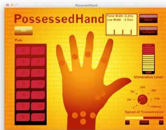
電極パッドの位置と電気刺激の大きさによって、前腕の筋肉を局所的に刺激し、脳の命令とは無関係に手指を動かすことができる『Possessed Hand (ポゼストハンド)』。米TIME誌の記事「ベスト50イノベーション」に掲載されるなど、世界から注目を集める。
