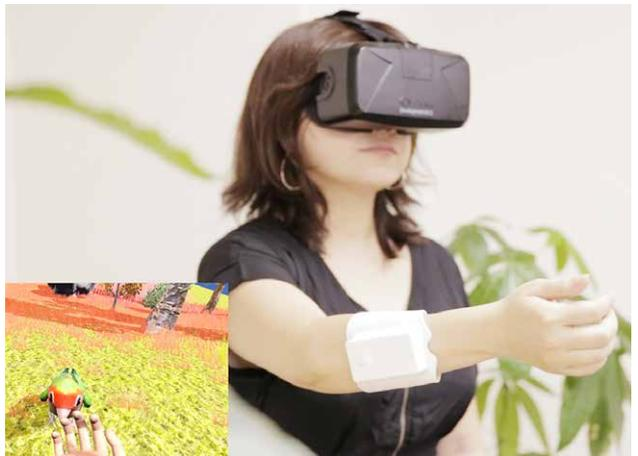
触感型ゲームコントローラ『UnlimitedHand(アンリミテッドハンド)』は、腕に巻いた装置に内蔵されたモーションセンサと筋変位センサにより、ユーザの手の動きをゲームに反映できる。さらに、機能的電気刺激によってユーザの筋肉を収縮させ、擬似的な触感も実現する。
